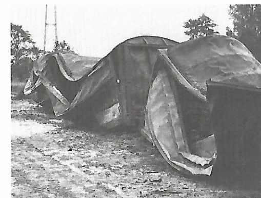
Die Brandhitze ist so stark, dass die Waggons sich stark verformen
