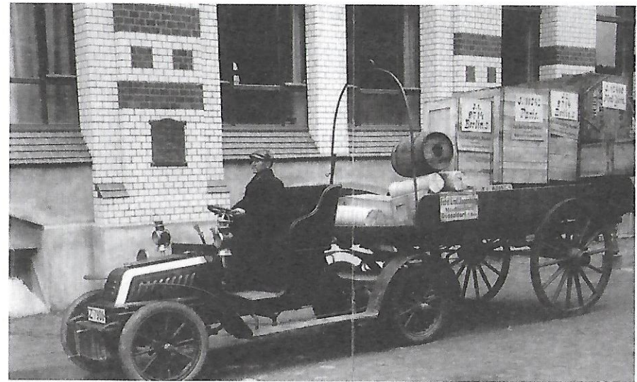
Den ersten Sattelschlepper der Welt erfand Emil Jagenberg jun. (Kaiserliches Patentamt, Patentschrift Nr. 168659 v. 21.8.1904). „Verbindung eines Motorwagens mit einem auf diesen mittels Drehkranzes sich stützenden Lastwagens“.
